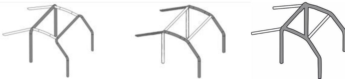
Ein Überrollkäfig mit mindestens einer Diagonalstrebe und einem Flankenschutz an der Fahrerseite ist vorgeschrieben. Der Rohrdurchmesser muss mind. 40 x 2 mm oder 38 x 2,5 mm betragen. Verstärkungsplatten zwischen Käfigfuß und Karosse müssen eine Größe von 100 x 100 x 2 mm haben. Ein Flankenschutz auf der Beifahrerseite wird empfohlen. Der Überrollkäfig muss über den kompletten Verlauf den Mindestrohrdurchmesser aufweisen und darf nicht beschädigt oder verjüngt sein.
