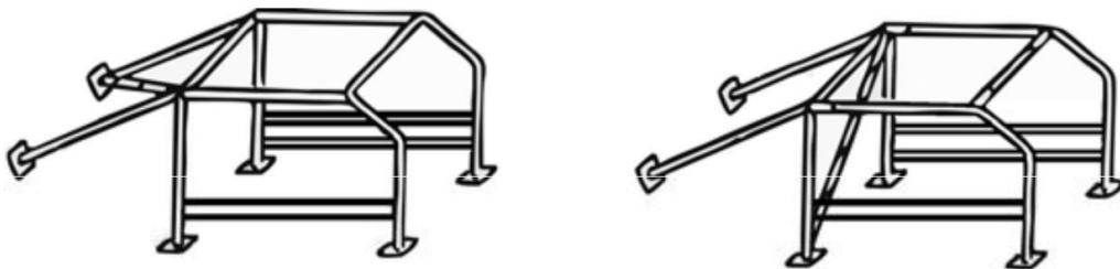
Eine zusätzliche Aussteifung des Käfigs im Bereich der A-Säule durch eine möglichst gerade Stützstrebe gemäß Zeichnung unten wird empfohlen, wenn das Maß A größer als 200 mm ist und es sich um sogenannte Eigenbaukäfige handelt.
