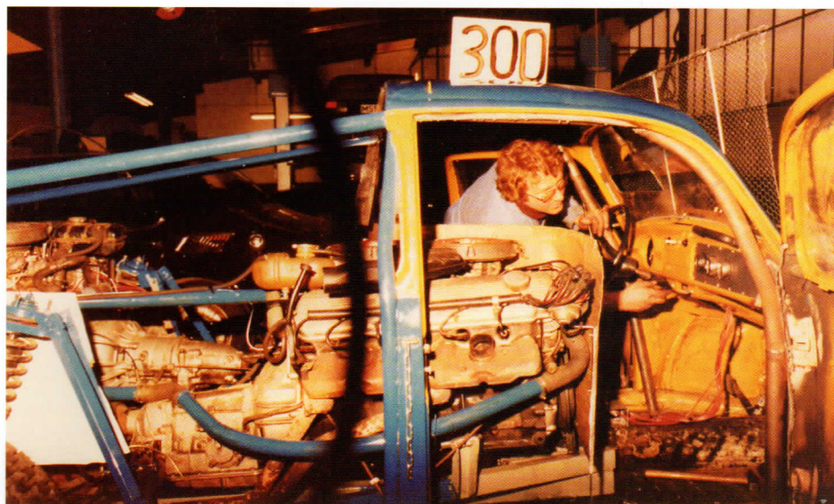
Diese Aufnahme zeigt die Einbaulage der beiden 3-Liter BMW-Automatik-Motore.
